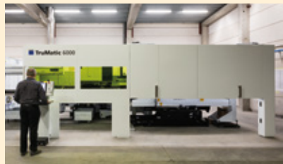
La machine polyvalente Trumatic 6000 fiber réunit deux technologies en un seul système.
